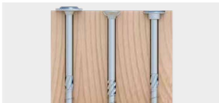
Par comparaison avec la vis à tête plate, la tête de la Sawtec pénètre de façon affleurante, comme une vis à tête fraisée, en raison de ses dents de scie.
