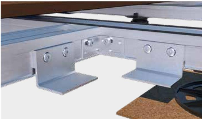
La cornière de charge peut être placée librement sur la longueur du profilé en aluminium et elle se fixe latéralement à l'aide de 2 vis BiGHTY.
