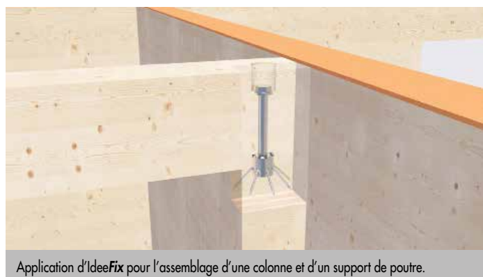
Cornière système CLT (bois lamellé croisé) avec IdeeFix
