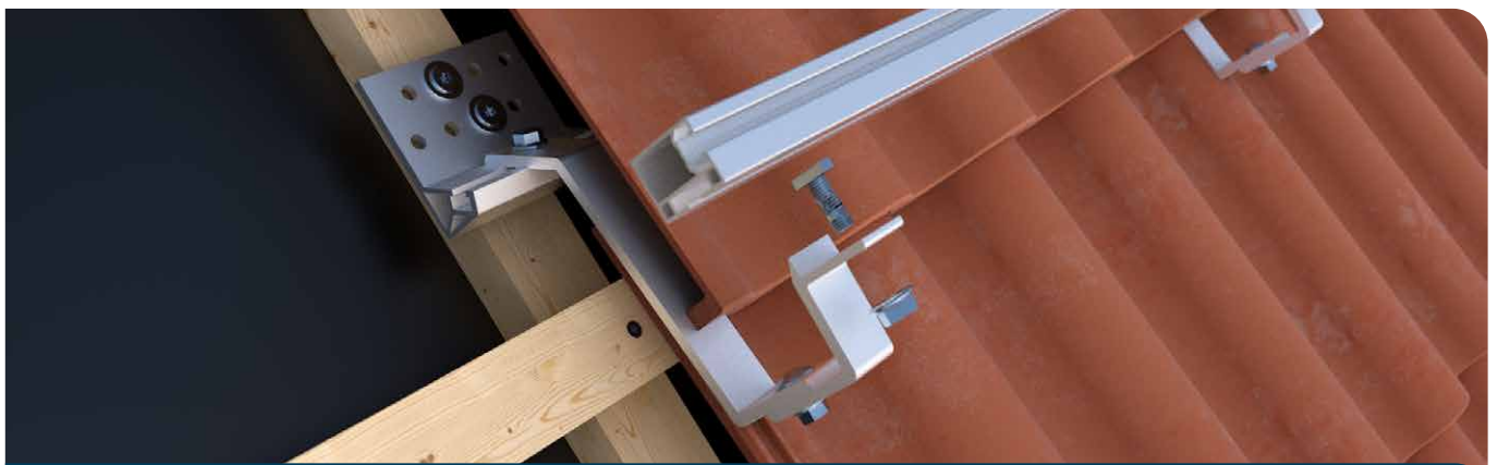
Dachhaken FIX-FIT Vario an der Konterlatte montiert, durch die ausgeklinkte Dachpfanne geführt und mit montiertem Montageprofil Steildach Slim befestigt.
