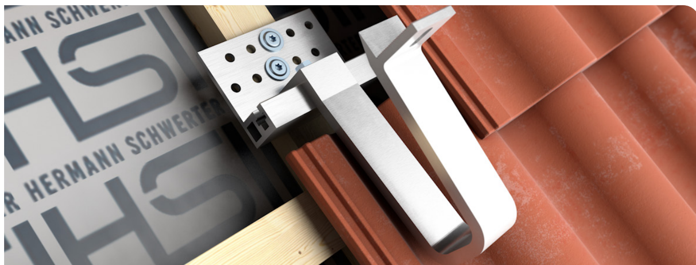
Der Dachhaken FIX-FIT V3 HEAVY wird an der Konterlatte montiert und mit dem bereits montierten Montageprofil FIX-FIT befestigt.
