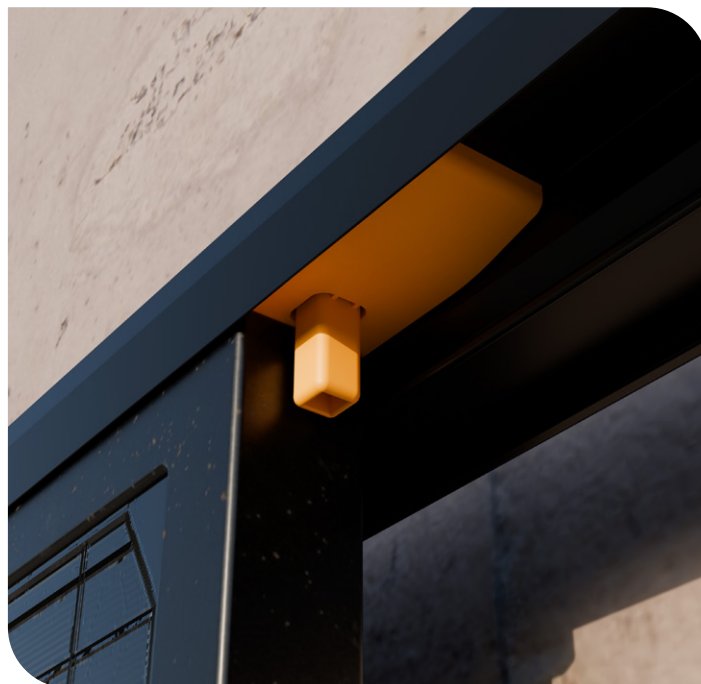
SCHRITT 11: Zwischen jedem Solarmodul wird in der oberen Einlege-schiene ein Abstandshalter LayTec eingesetzt. Dieser stellt automatisch einen Abstand von 10 mm zwischen den Solarmodulen her und verhindert ein Herausrutschen der Module nach oben. (Hinweis: Die orange Farbe dient lediglich der Darstellung; der Abstandshalter ist in der Ausführung schwarz.)
