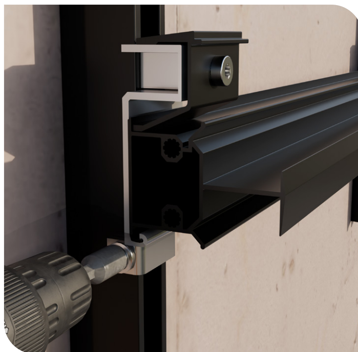
SCHRITT 8: Fassadensicherung unterhalb des Profilverbinders anlegen und mit Bighty Schraube am Basisprofil befestigen.
