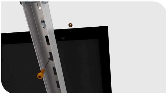
**SCHRITT 4:** Solarmodul in die richtige Position bringen und die Schraube durch die Öffnung der Modulhalterung sowie durch das Modul selbst und anschließend in die Mutter stecken.
