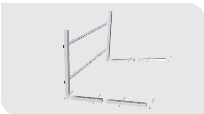
**SCHRITT 2:** Profile wie dargestellt montieren.
