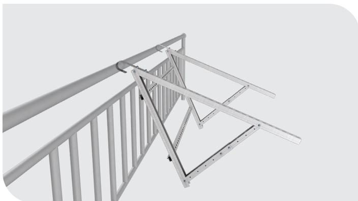
**SCHRITT 6:** Balkonhalterung einhängen. (Solarmodul ausgeblendet)
