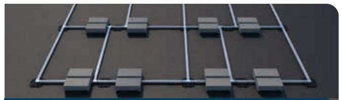
**Schritt 2:** Positionieren Sie die Ballastwannen, um eine möglichst gleichmäßige Verteilung der Lasten zu ermöglichen (mehr Infos finden Sie in der Montageanleitung).
