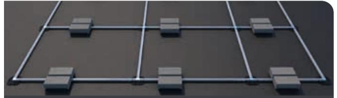
**Schritt 2:** Positionieren Sie die Ballastwannen, wie in diesem Beispiel, an allen Montageprofilen der Länge L1 und L3 (mehr Infos finden Sie in der Montageanleitung).
