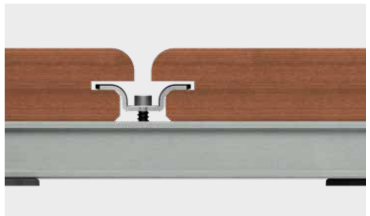
Der V-Clip in einem Terrassenbelag mit asymmetrischer Nut.
