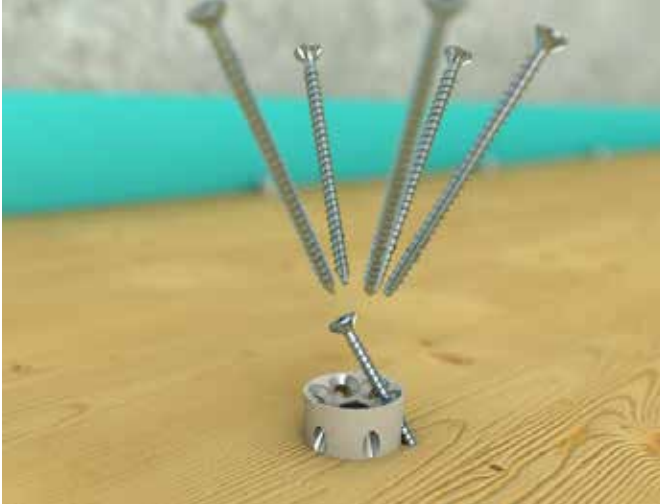
Schritt 3: Setzen Sie die sechs KonstruX 6,5 mm x 100 mm Schrauben in jedes Loch des Stahlzylinders ein und ziehen sie nacheinander gleichmäßig an, um zu verhindern, dass sich der Zylinder aus der Position bewegt.
