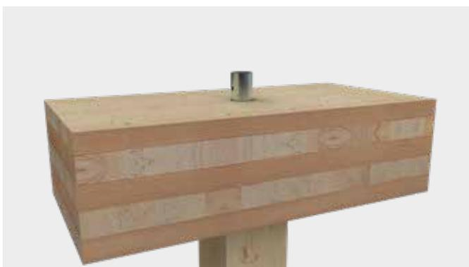
Schritt 5: Aufsetzen des Deckenelements.
