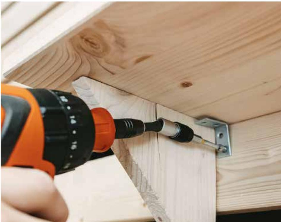
Anwendungsbeispiel: Befestigung eines Winkels an einer schwer zugänglichen Stelle mithilfe des schwenkbaren Bithalters.
