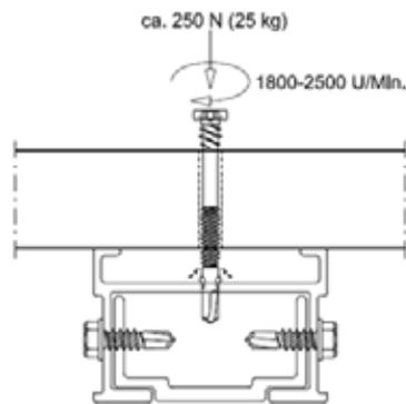
6. Die Drehzahl geht beim Greifen des Gewindes nach unten und die Schraube fängt an die Diele nach unten zu ziehen...
