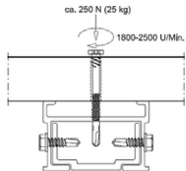
7. Der Schraubvorgang sollte beendet werden wenn der Schraubenkopf bündig mit der Dielenoberfläche abschließt.
