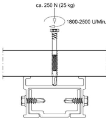
5. Die Bohrschraube formt ihr Gegengewinde in dem Befestigungssteg...
