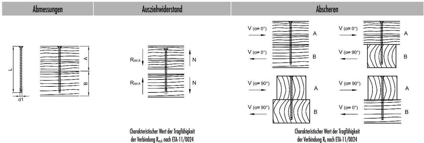
Charakteristischer Wert der Tragfähigkeit der Verbindung  $R_{ax,k}$  nach ETA-11/0024
