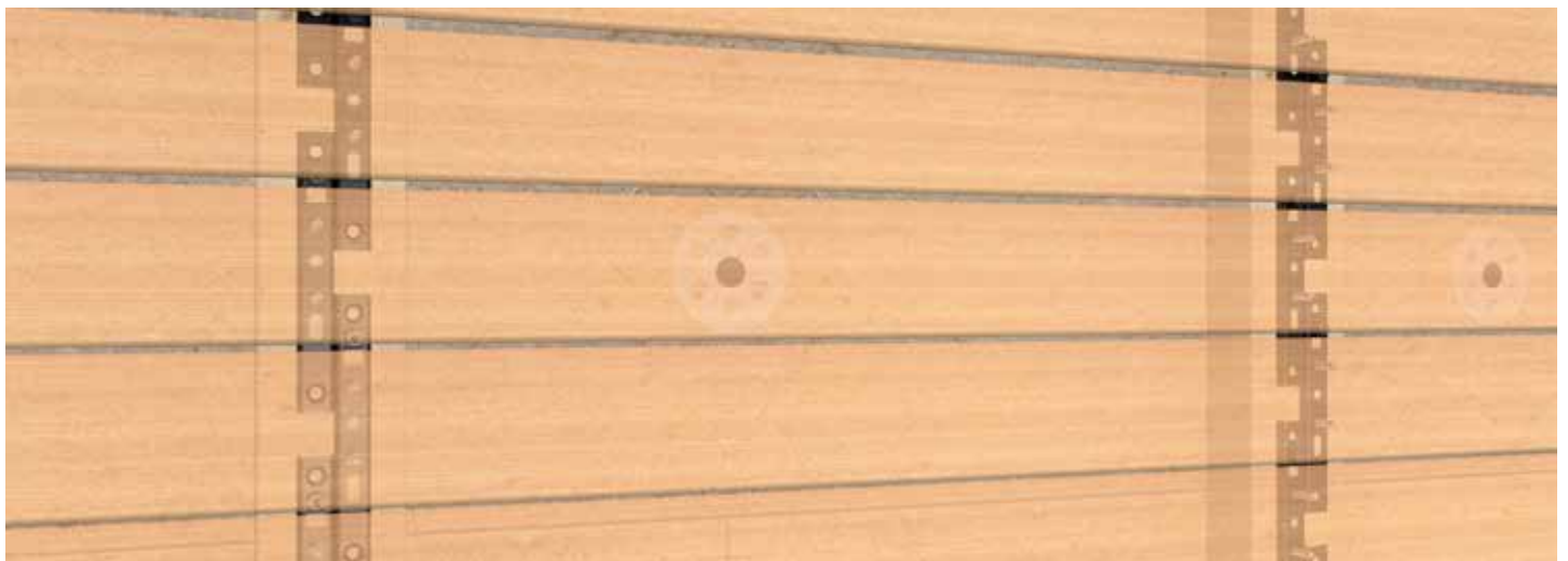
Fassadenclip auf Holzunterkonstruktion mit hölzernen Fassadenprofilen.
