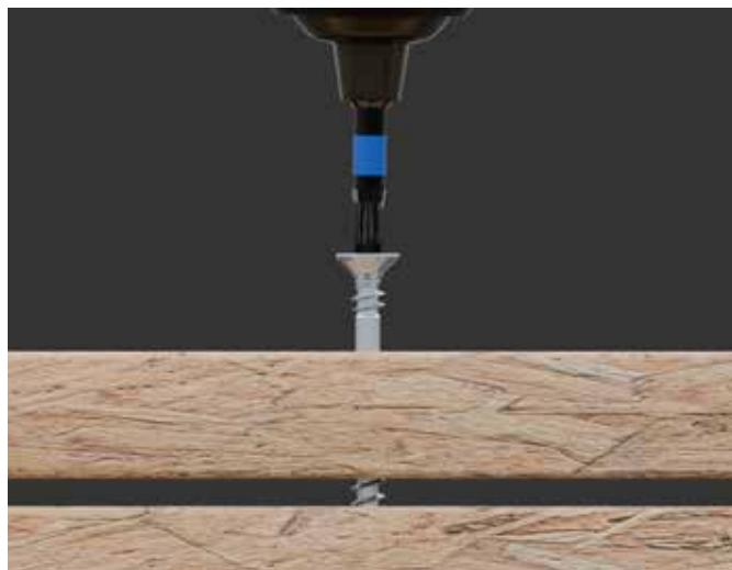
Ohne vorherige Befestigung entsteht durch das Einschrauben ein Spalt zwischen den Bauteilen.
