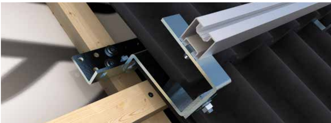
Dachhaken FLEX an der Konterlatte montiert, durch die ausgeklinkte Dachpfanne geführt und am Montageprofil Steildach befestigt.
