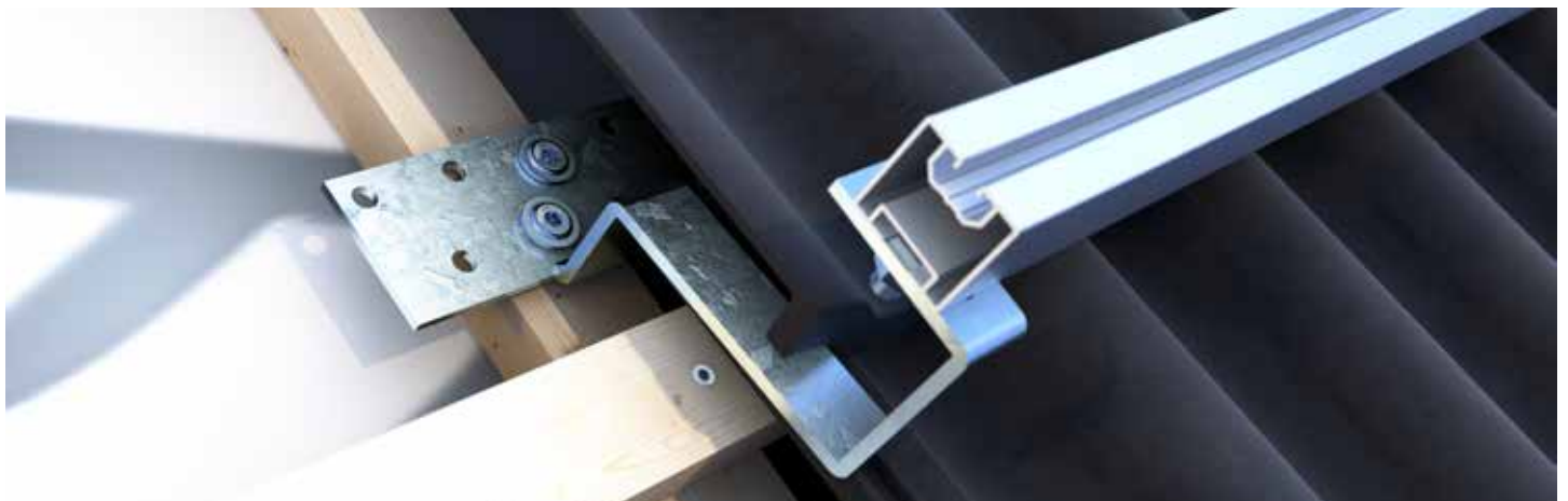
Dachhaken BASIC an der Konterlatte montiert, durch die ausgeklinkte Dachpfanne geführt und mit montiertem Montageprofil Steildach befestigt.
