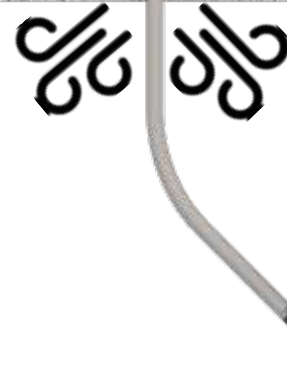
Schritt 2: Das Bohrloch gründlich reinigen.
