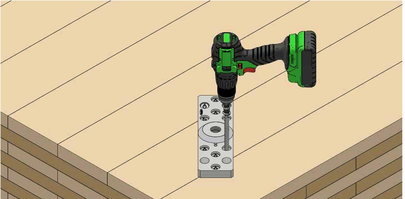
*Schritt 1: Die passenden KonstruX-Schrauben je nach Konfiguration (siehe technische Daten) einschrauben.*
