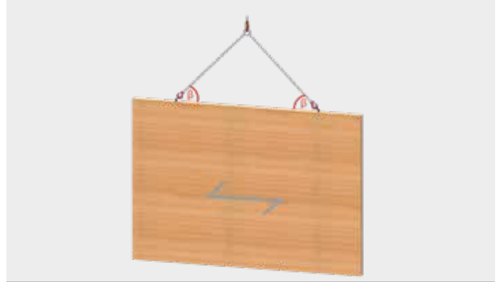
BSH-Wand oder -Träger stehend, Faserverlauf: horizontal
