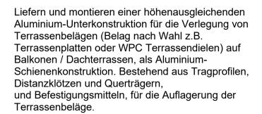
Material:Aluminium EN AW 6063-T66Abmessungen:(BxHxL)60 x 40 x 4000 mm
